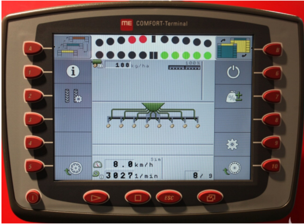
Resim 3: Tohum ekme makinasını kumanda eden ISOBUS terminali
